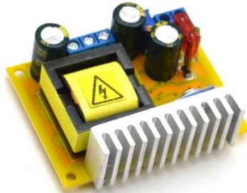
Figura 16 - Módulo Conversor DC-DC de alta tensão.
