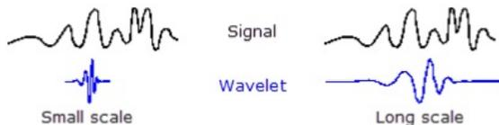
Figura 10 – Duas escalas da *Wavelet* mãe para representar o sinal [9].
