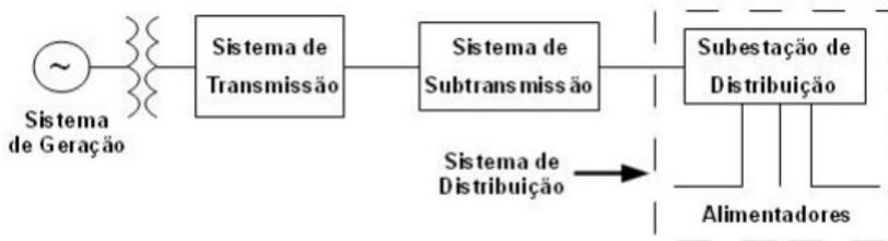
Figura 1 – Arquitetura do Sistema Elétrica de Potência [3].
