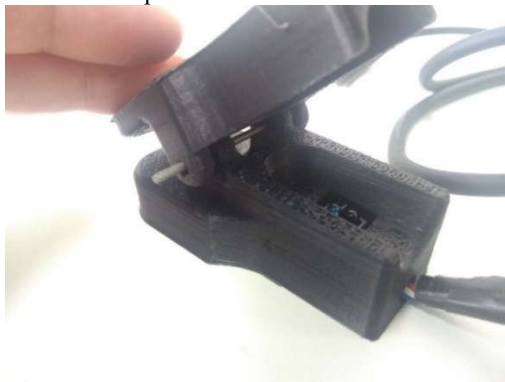
Figura 59 – Case do sensor óptico finalizado
