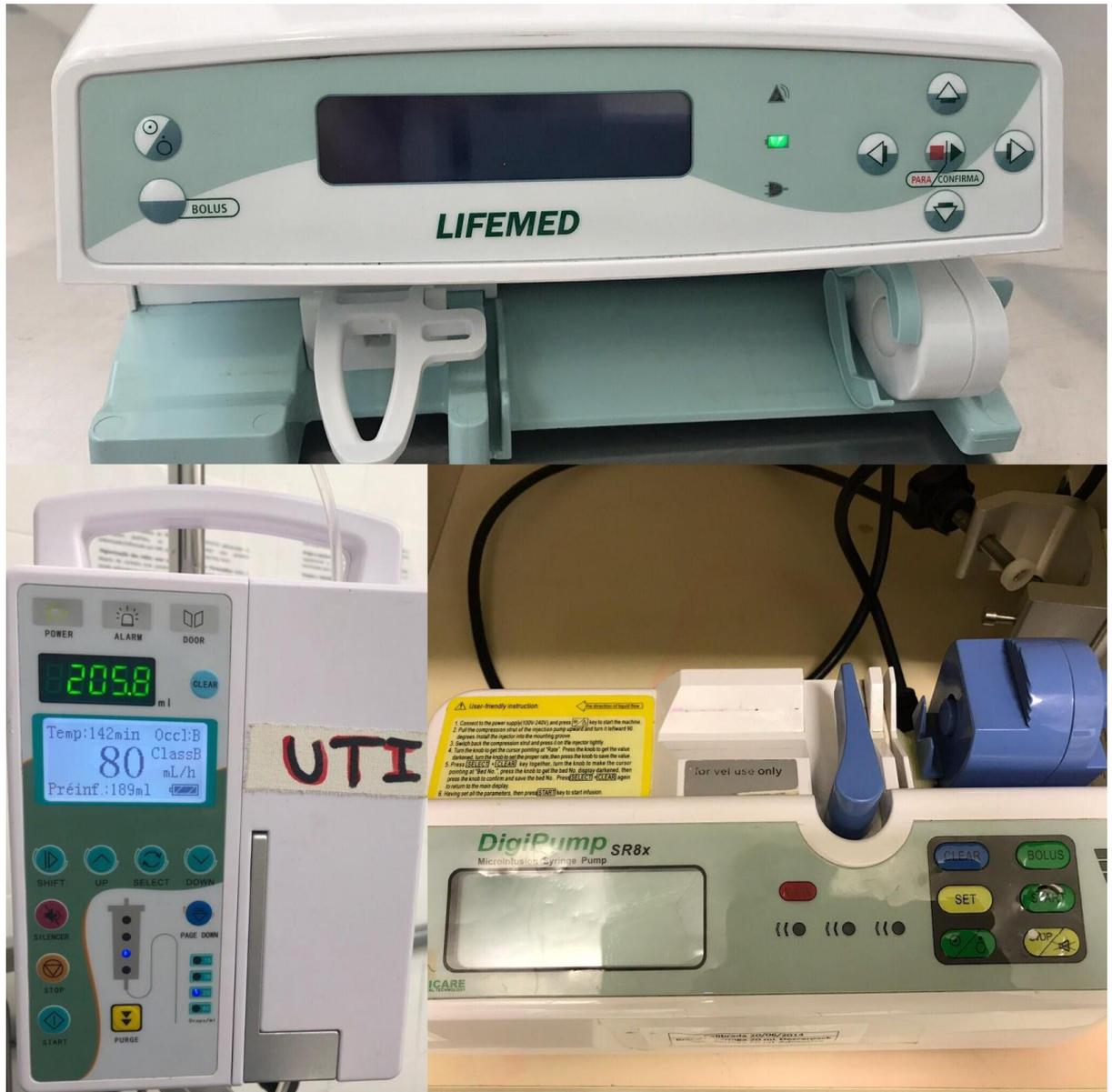
Figura 35 - Bombas de seringa e infusão utilizados na UTI do HV - UFPR. (Fonte: Arquivo Pessoal, Curitiba, 2018).
