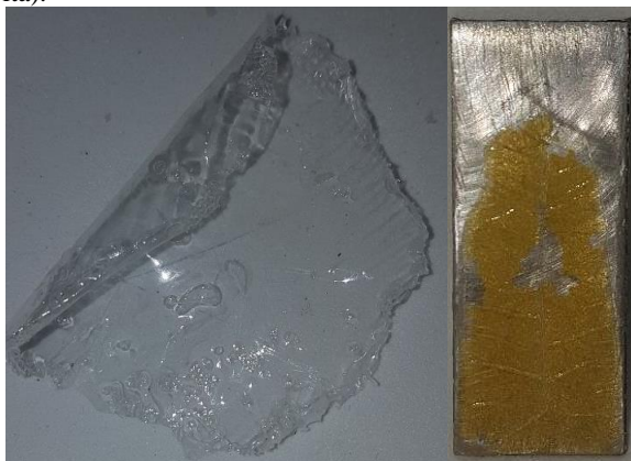
Figura 18. Comparação entre um filme de PEI (esquerda) e um do derivado PEI-B (direita).
