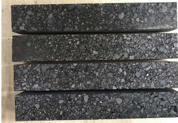
Figura 25 - Corpos de prova serrados, prontos para o ensaio de fadiga.
