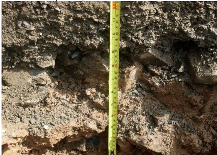
Figura 11 - Determinação as espessuras das camadas existentes.
