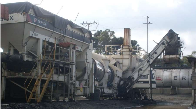
Figura 21 - Usina misturadora TEREX MAGNUM 140 A.
