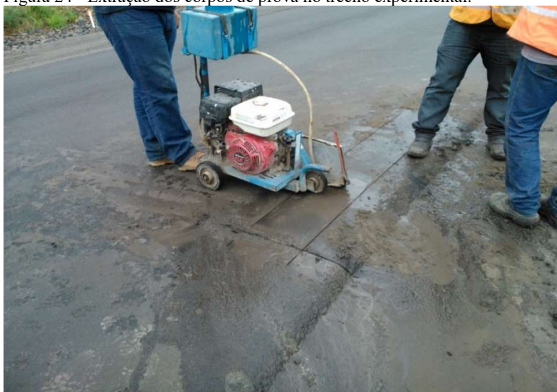
Figura 24 - Extração dos corpos de prova no trecho experimental.
