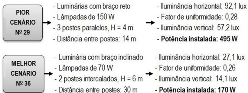
Figura 69: Melhor e pior cenários simulados com a lâmpada a vapor metálico
