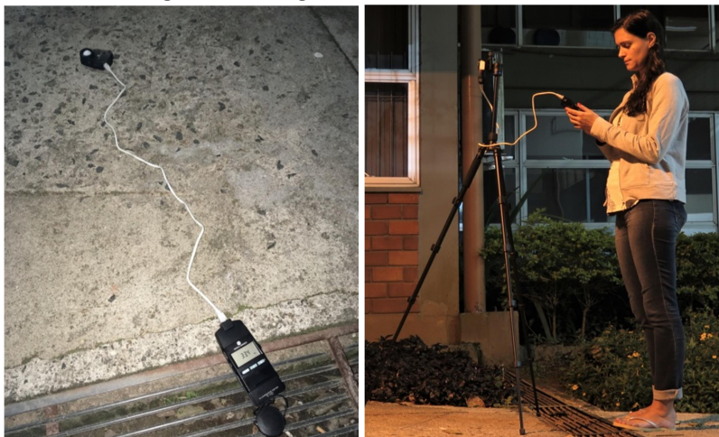
(a) medição de iluminamento horizontal
