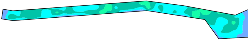
Figura F.2 – Distribuição de iluminação horizontal (em lux) dos cenários 25 a 48 simulados no DIALux com lâmpadas a vapor metálico (cont.)
