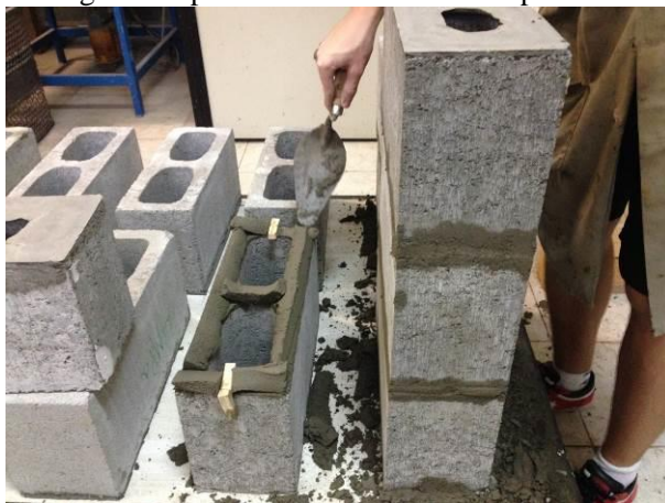
Figura 19 – Moldagem dos prismas de 3 fiadas no tempo inicial.
