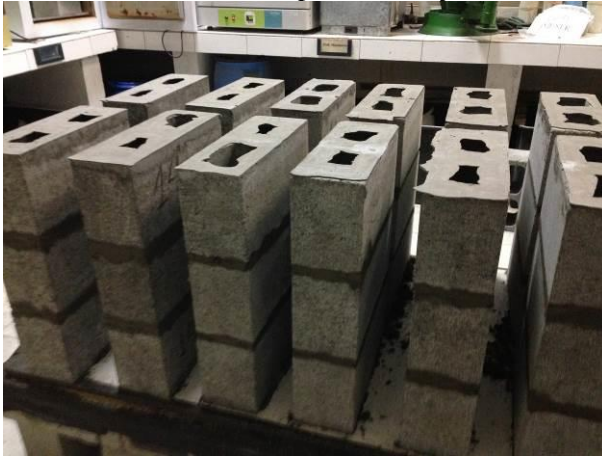
Figura 21 – Prismas de 3 fiadas no tempo de utilização (24 horas).
