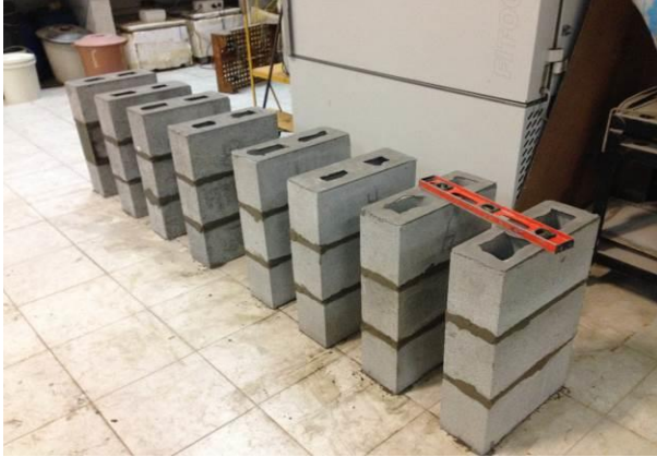
Figura 20 – Prismas de 3 fiadas no tempo inicial.
