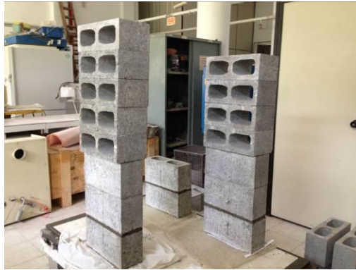
Figura 15 – Simulação da carga de assentamento como medida da deformabilidade.
