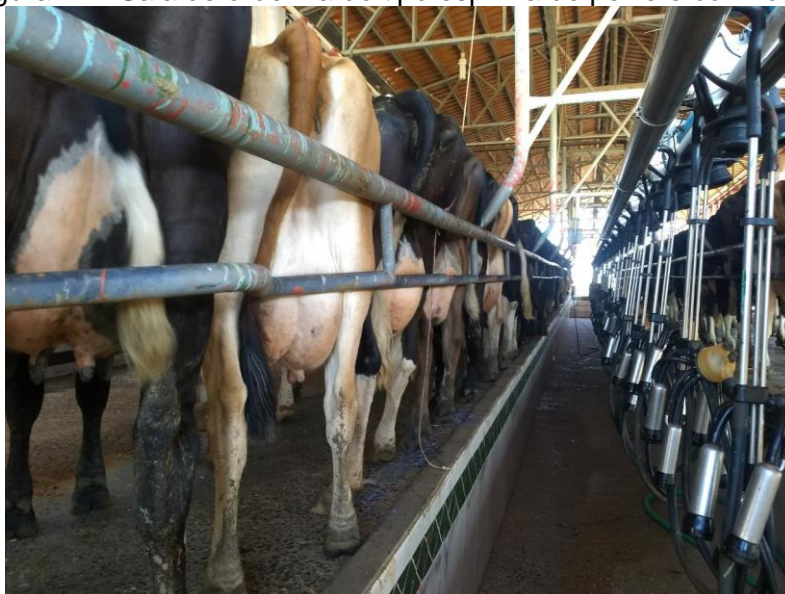
Figura 17 - Sala de ordenha do tipo espinha de peixe e com fosso.
