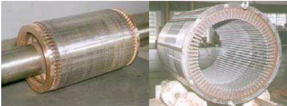
Figura 1.2 – Rotor e estator, respectivamente, de um típico motor de indução
