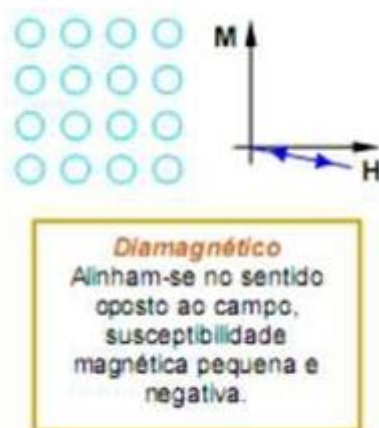
Figura 4. Gráfico da susceptibilidade \chi para os materiais diamagnéticos em que a magnetização M apresenta comportamento inverso e negativo à direção do campo magnético H aplicado. (CUNHA, 2014) [23] .
