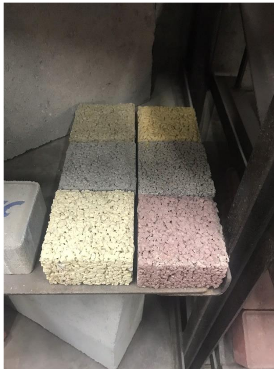
Figura 10 – Peças coloridas com o uso de pigmentos inorgânicos
