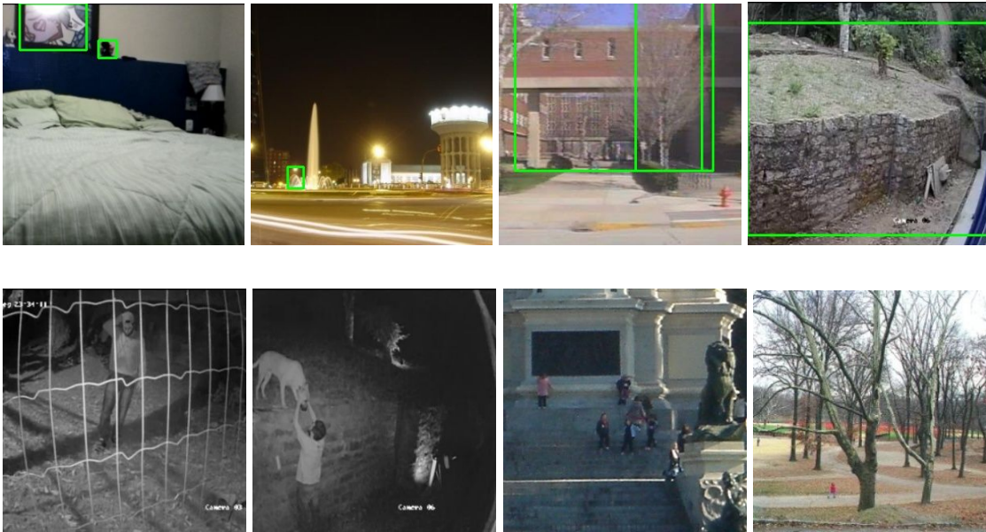
Figura 20: Erros cometidos pelo modelo Pelee. Acima: exemplos de falsos-positivos. Abaixo: exemplos de falsos negativos.
