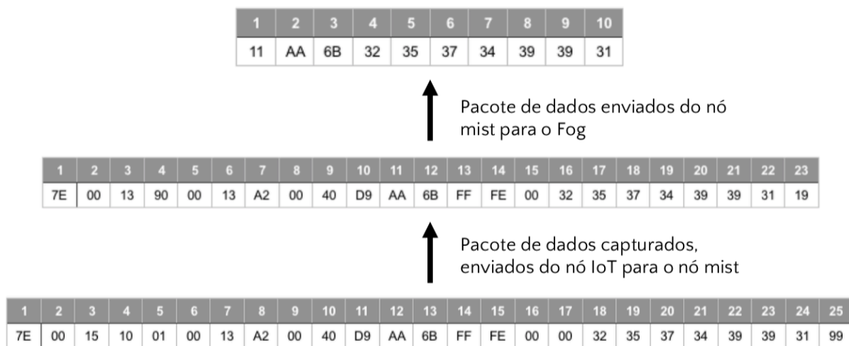
Figura 26 – Envio dos dados capturados pelo nó IoT para o nó Mist e para a Fog, de forma resumida.
