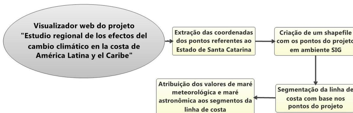
Figura 8 – Processo de obtenção das amplitudes de maré astronômica e meteorológica.
