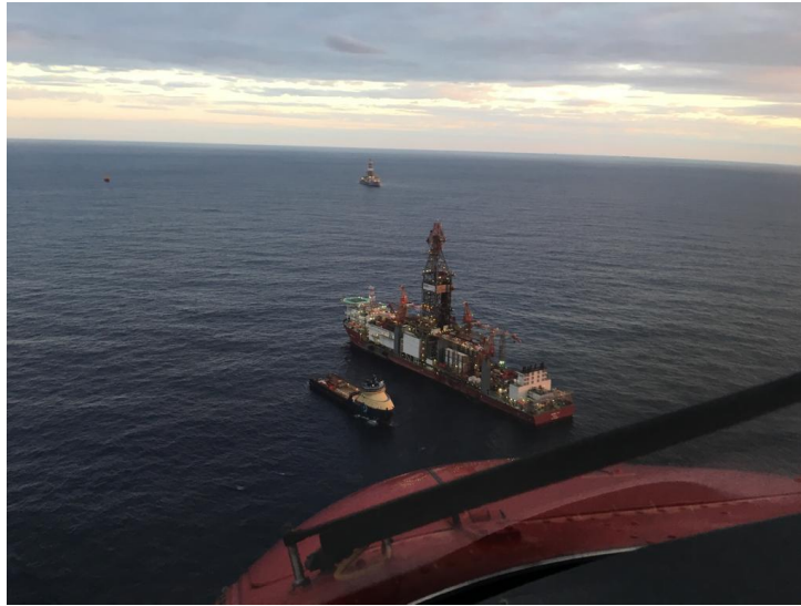
Figura 26- Helideck na proa com boa distancia vertical em relação ao mar
