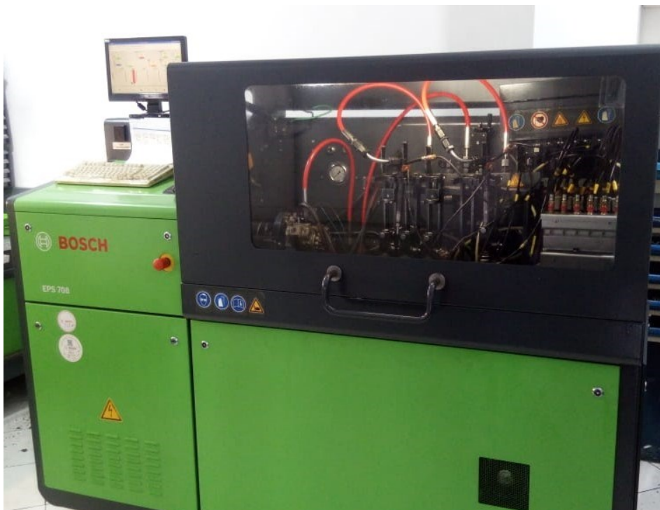
Figura 7 - Bancada de Teste de Bombas e Injetores Diesel - EPS 708
