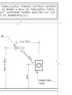
10 DETALHE DE INSTALAÇÃO DOS PONTOS DE "GLP" E ELÉTRICO NA COZINHA SEM ESCALA
