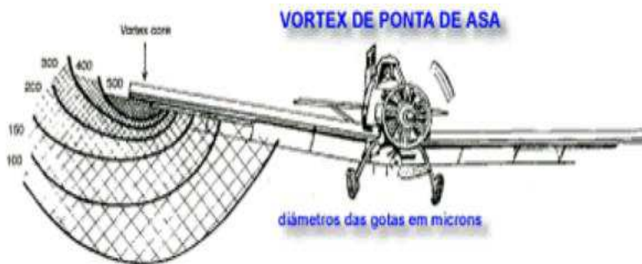
Figura 4: Ilustração do efeito vortex de ponta da asa. Fonte: Rede Agronomia, 2018.
