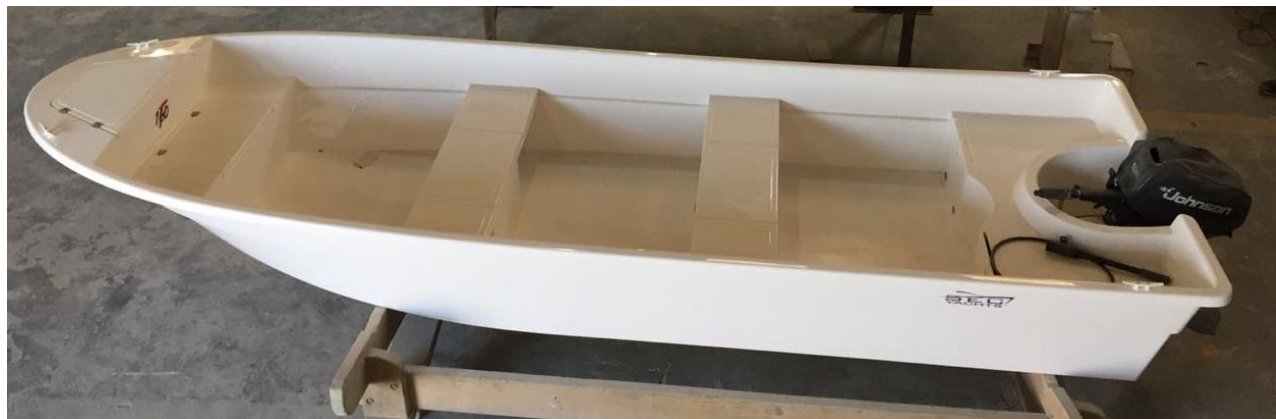
Figura 17 – Instalação do motor de popa na 160F
