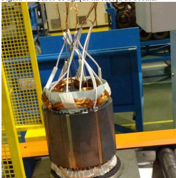
Figura 4 – Cabos de ligação na cabeça de bobina.
