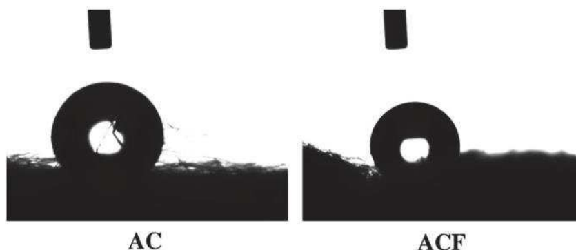
Figura 13 - Ângulo de contato do Algodão cru (AC) e Algodão caustificado (ACF) com água.
