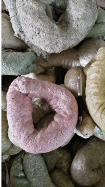
Figura 10 - “Roscas” de EPS após o processamento no protótipo da Meiwa.
