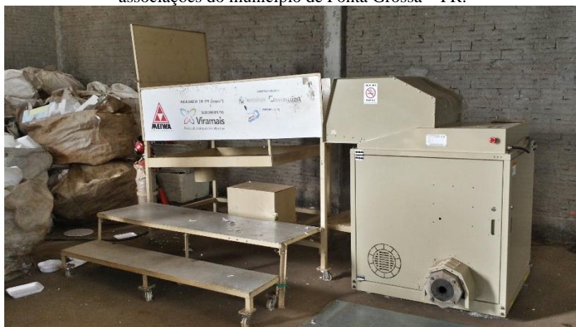
Figura 9 - Protótipo para reciclagem de EPS fornecido pela MEIWA às associações do município de Ponta Grossa – PR.
