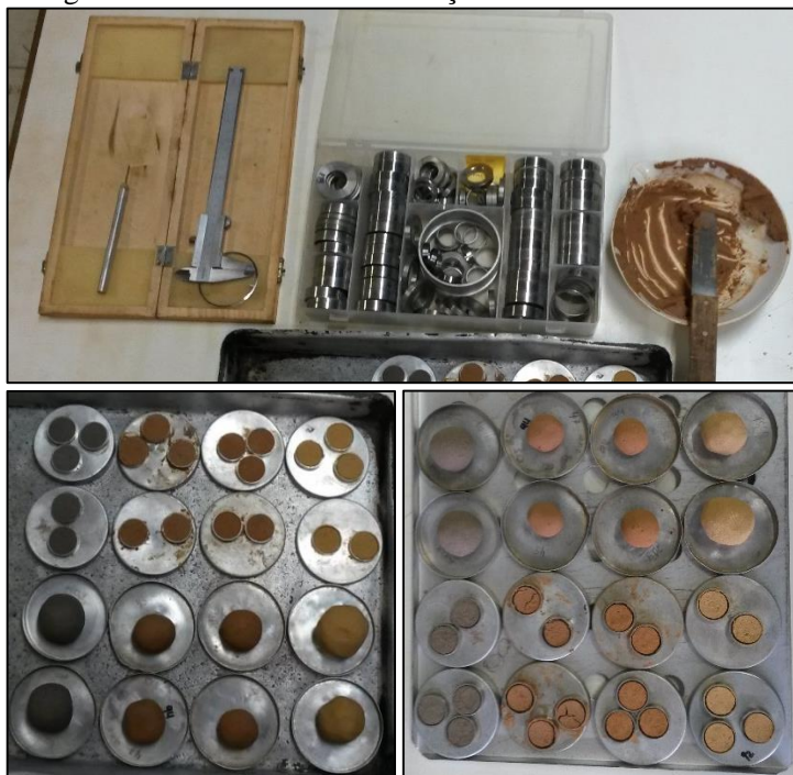
Figura 41 - Ensaio de caracterização MCT.
