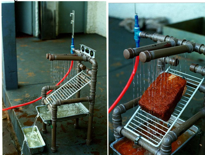
Figura 17 - Ensaio de Inderbitzen modificado.
