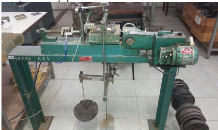
Figura 36 - Equipamento do ensaio de cisalhamento direto.
