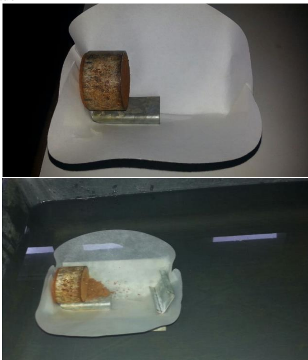
Figura 40 - Esquema do ensaio de perda de massa por imersão modificado
