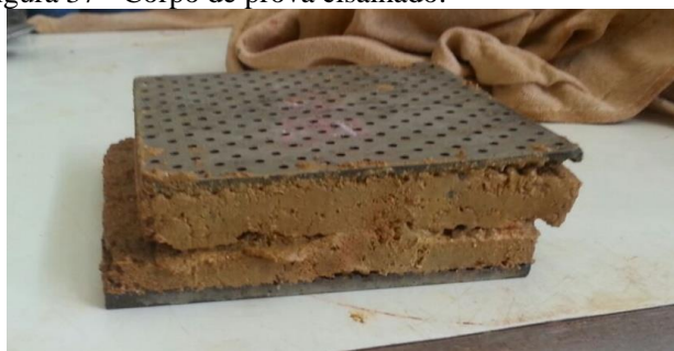
Figura 37 - Corpo de prova cisalhado.
