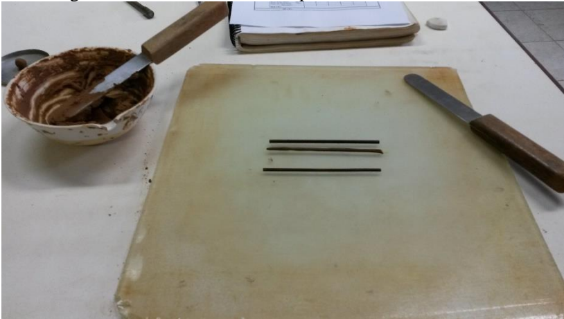
Figura 35 - Ensaio de limite de plasticidade.
