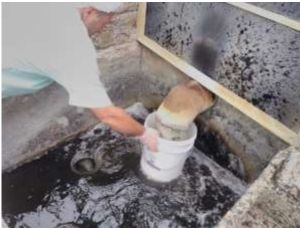
Figura 35 – Coleta de efluente e aferição de vazão pelo método balde e cronômetro na caixa de passagem entre as duas lagoas (Ponto E) (21/02/17).
