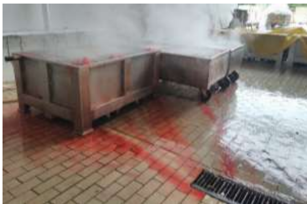
Figura 9 – Cozimento da beterraba, com saída de efluente de coloração avermelhada direcionada ao sistema de drenagem – 07/02/17.
