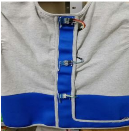
Figura 47: Forma como os sensores devem ser costurados no produto de vestuário.
