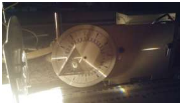
FIG. V.16: feixe de luz branca incidindo em prisma de vidro. Fonte: arquivo do pesquisador.
