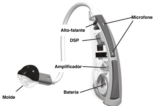
Figura A.4: Esquema de um aparelho auditivo de amplificação sonora individual (adaptado de www.hiddenhearing.ie ).
