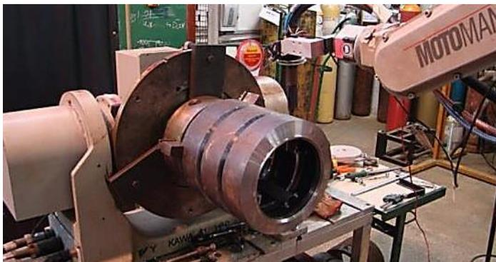
Figura 105. Bancada de soldagem do passe de raiz em tubos.
