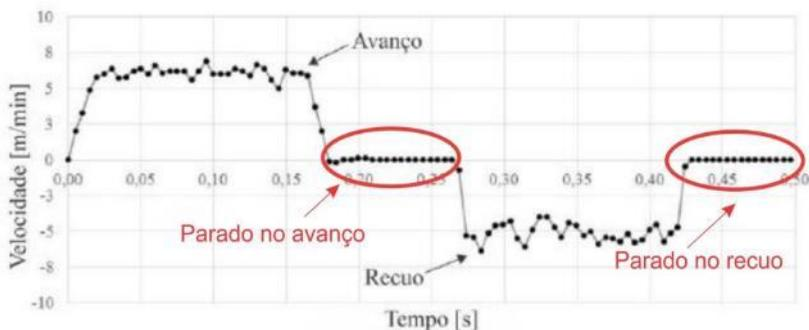
Figura 16. Movimento real do arame em avanço e recuo para alimentação em baixa frequência [32].
