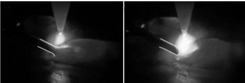
Figura 12. Interrupção no contato do arame com a poça no pulso de corrente [33].
