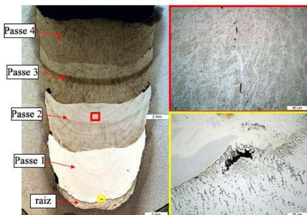
Figura 5. Soldagem de peças cladeadas com a utilização de material *buffer* [15].
