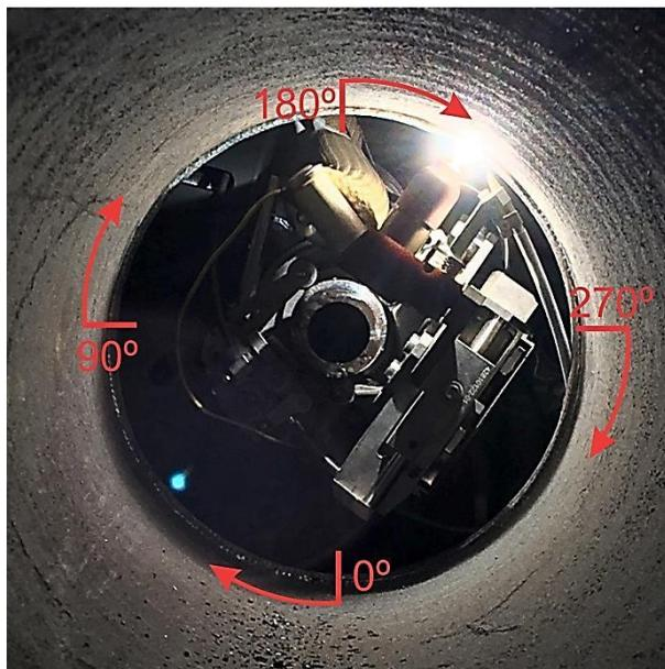
Figura 78. Soldagem orbital interna, divisão da circunferência interna e sentido de soldagem.
