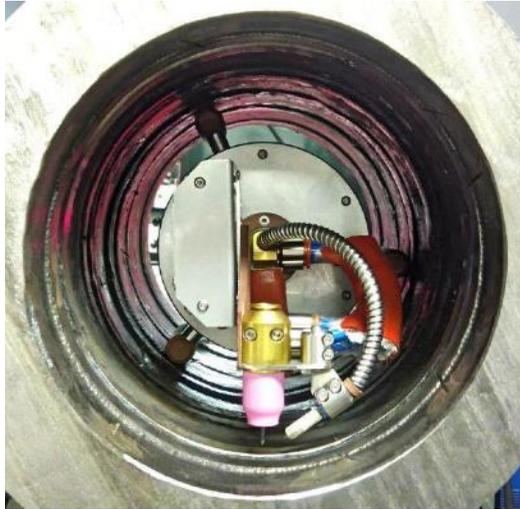
Figura 91. Fixação do CSI em posicionamento para soldagem.
