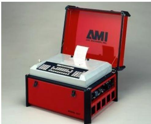
Figura 43. Fonte de soldagem Modelo 227 [57].
