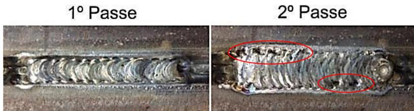
Figura 56. Aspecto superficial da condição C5 para posição sobre cabeça.
