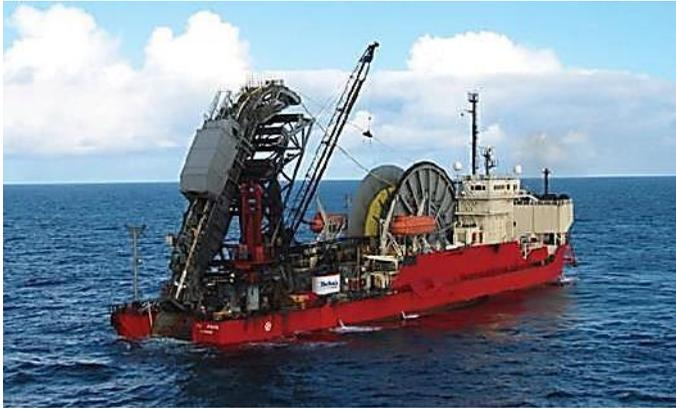
Figura 2. Embarcação *Technip's Apache* para instalação *reel-lay* [7].
