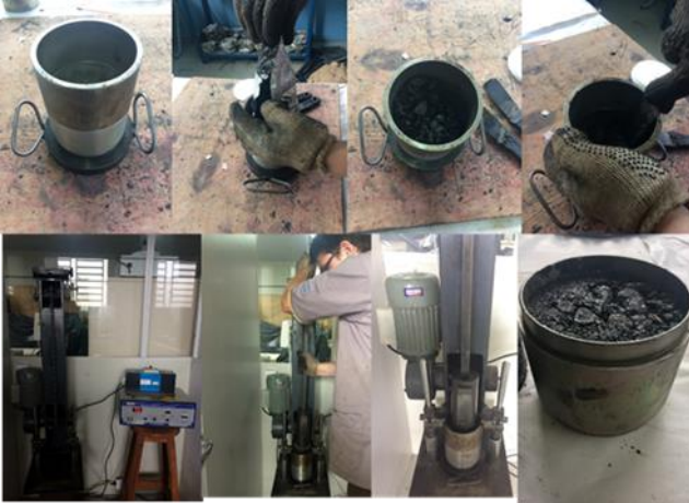
Figura 7.5 - Procedimento para a compactação da mistura asfáltica
