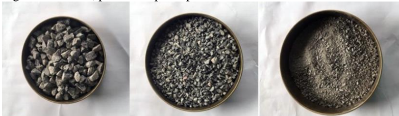
Figura 2.2 - Brita, pedrisco e pó de pedra
