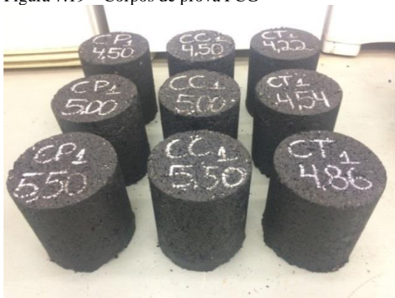
Figura 7.19 – Corpos de prova PCG
