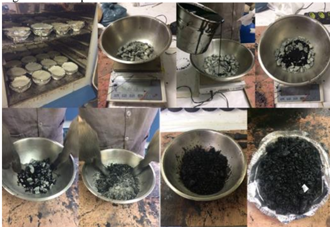
Figura 7.4 - Preparo da mistura asfáltica
