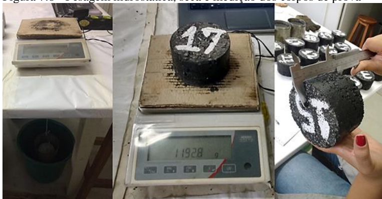
Figura 7.8 - Pesagem hidrostática, seca e medição dos corpos de prova
