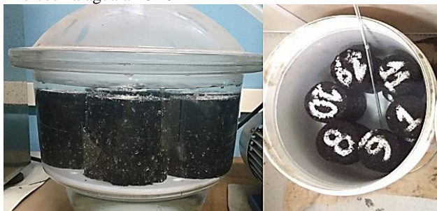
Figura 7.25 - Corpos de prova durante o processo de saturação à vácuo e imersos na água à 18 °C
