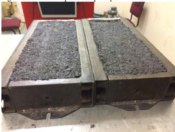
Figura 7.32 - Placas após a compactação
