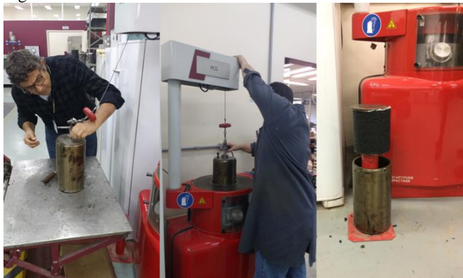
Figura 7.17 – Procedimento ensaio PCG
