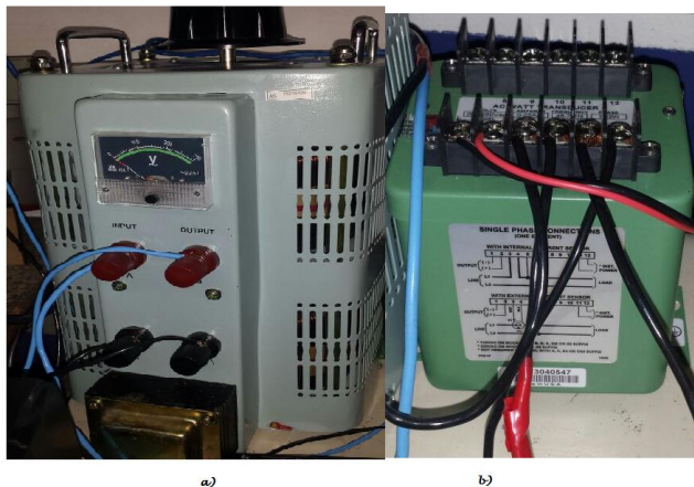
Figura 4.4: a) Fonte de potência b) transdutor de potência
