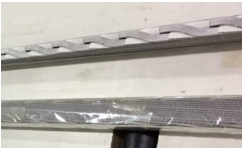
Figura 19 - Barra após a dobra dos fios indicando a região em formato de “S” (Cortesia: WEG Equipamentos Elétricos S.A.)
