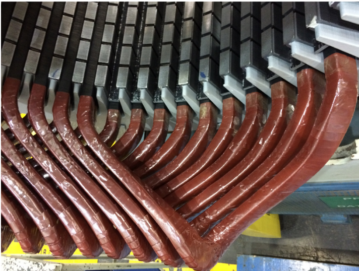
Figura 13 - Enrolamento distribuído imbricado (Cortesia: WEG Equipamentos Elétricos S.A.)
