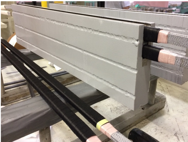
Figura 73 - Inserção das barras no segmento de chapa
