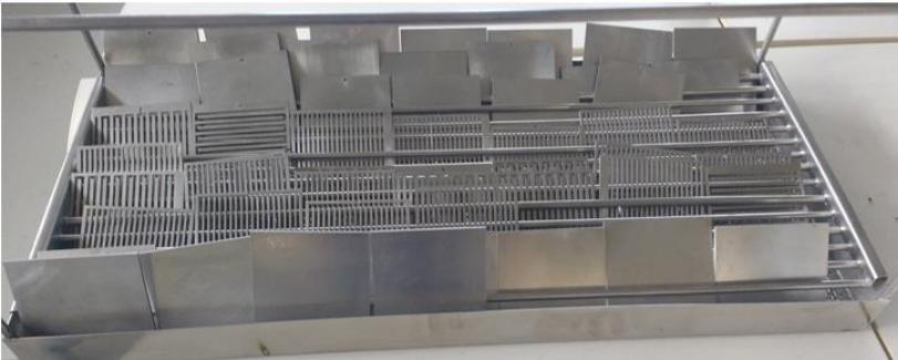
Figura 4.2 - Peças posicionadas no banho ultrassônico.
