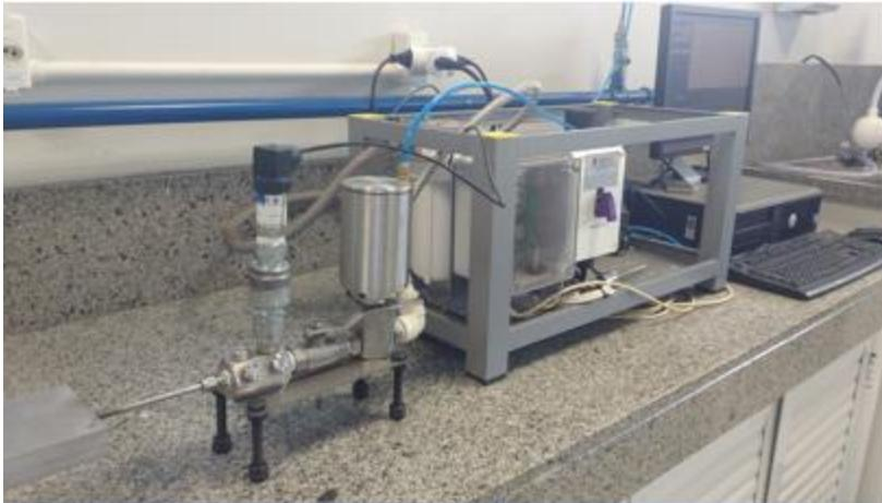
Figura 4.12 - Bancada de monitoramento de pressão hidrostática
