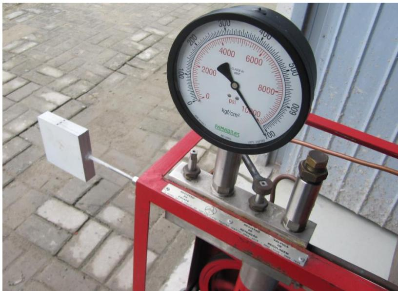
Figura 5.11 - Corpo de prova pressurizado a 700 bar
