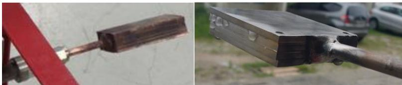
Figura 4.11 - Amostras testes em cobre e aço inoxidável
