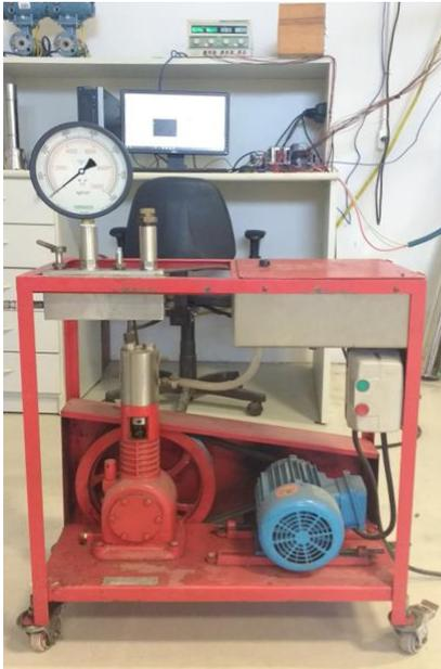
Figura 4.14 - Bancada para ensaios hidrostáticos de até 700 bar
