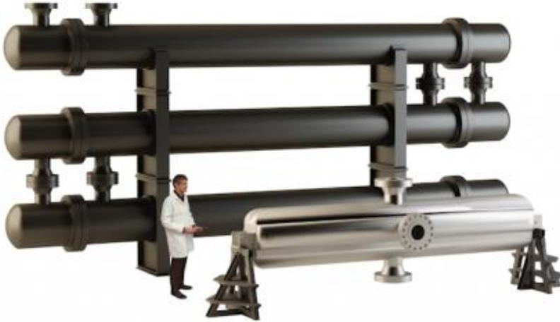
Figura 2.2 – Equivalência de tamanho entre trocadores de mesma capacidade térmica [9]
