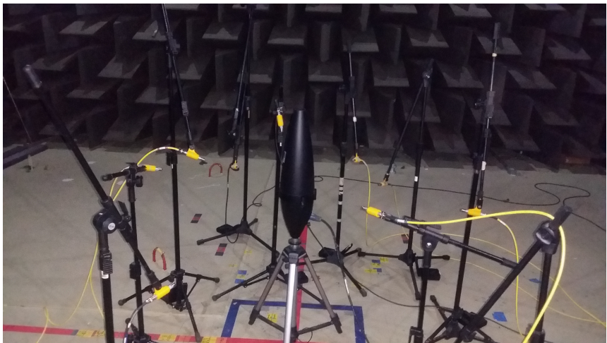
Figura 14 – Foto do Experimento de medição da Potência Sonora da Fonte Omnidirecional Brüel and Kjaer 4295 seguindo norma ISO3795.
