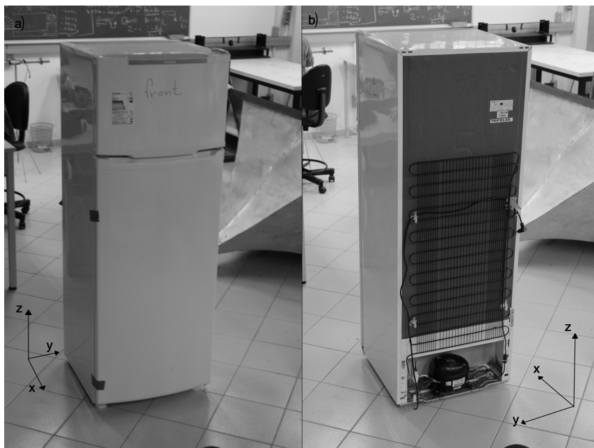
Figura 24 – Foto das laterais do refrigerador, com os eixos coordenados da convenção deste trabalho. a) laterais frontal e LD. b) laterais atrás e LE.
