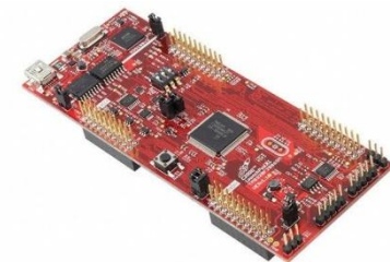
Figura 2.99 – Kit de desenvolvimento LAUNCHXL-F28069 do fabricante Texas Instruments .
