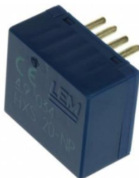
Figura 2.96 – Sensor de corrente HXP 20-NP do fabricante LEM.
