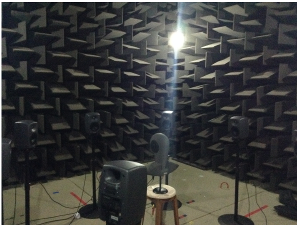
Figura 4.14.: Simulador de tronco e cabeça posicionado no centro do octógono formado pelos alto falantes na câmara semi anecoica do LVA.
