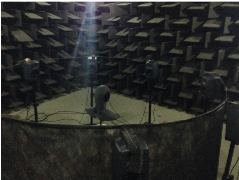
Figura 3.1.: Imagem da montagem do sistema na câmara semianecoica.
