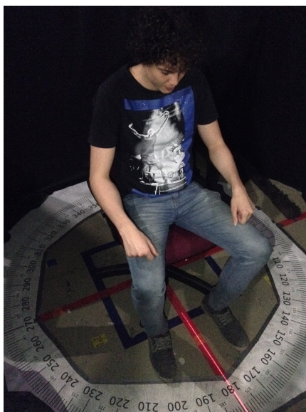
Figura 4.17.: Sujeito posicionado para o ensaio de localização de fontes sonoras (dentro da câmara semianecoica).
