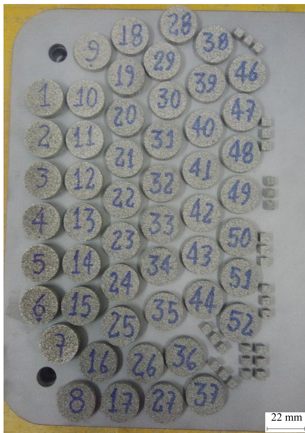
Figura 4.40 – Amostras logo após serem fabricadas no equipamento M2 Cusing – Método 01.
