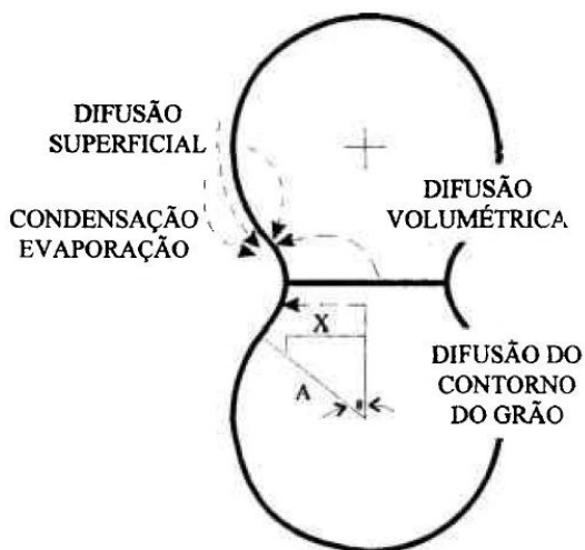
Figura 2.32 – Mecanismos de transporte de massa durante a sinterização.
