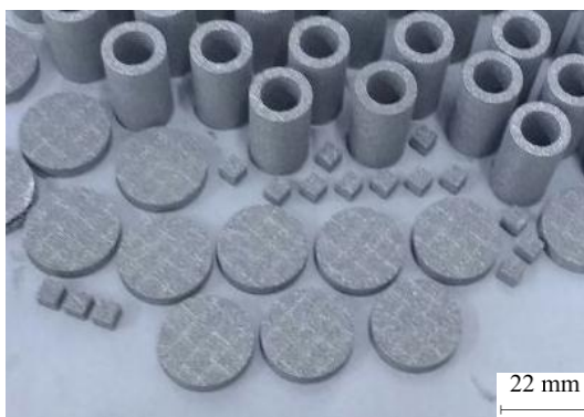
Figura 4.79 – Amostras FGM 304 (cubos) logo após serem fabricadas no equipamento M2 Cusing – Método 02.
