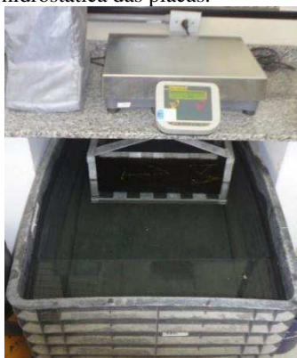
Figura 4.10 – Pesagem hidrostática das placas.
