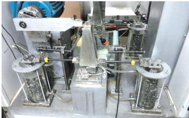
Figura 4.21 – Ensaio de módulo complexo com imersão em água dos Corpos de Prova (CPs).
