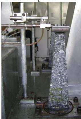
Figura 3.21 – Ensaio à flexão de dois pontos.
