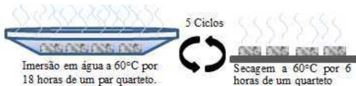
Figura 4.17 – Processo de condicionamento alternado dos Corpos de Prova (CPs).
