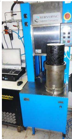
Figura 4.3 – Prensa de Compactação Giratório: modelo IPC-SERVOPAC.
