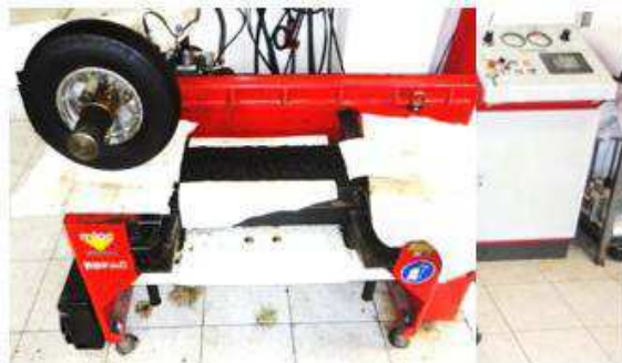
Figura 4.9 – Mesa compactadora de placas com uma roda lisa.
