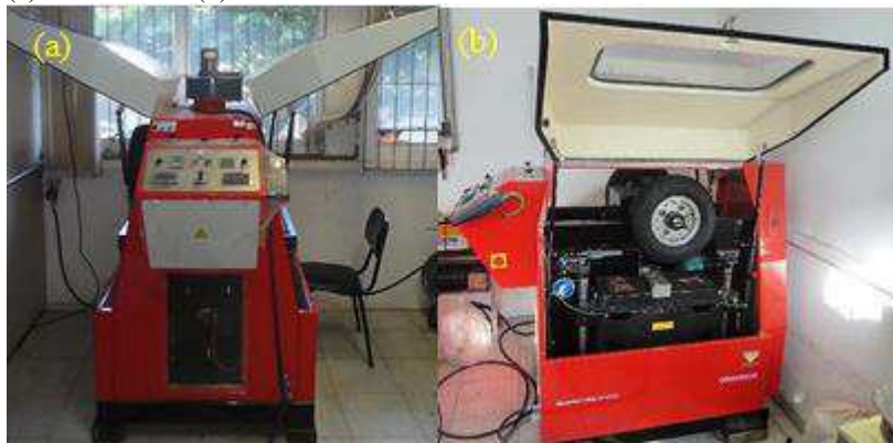
Figura 4.11 – Equipamento do ensaio de deformação permanente - lado frontal (a) e lado lateral (b).
