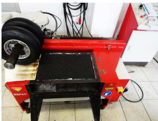
Figura 4.13 – Mesa compactadora de placas com eixo simples de roda dupla lisa.
