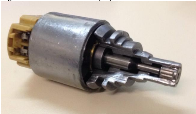
Figura 4.7 - Válvula solenoide proporcional normalmente fechada.
