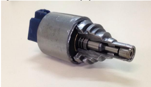
Figura 4.9 - Válvula solenoide proporcional normalmente aberta.
