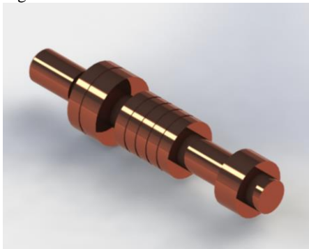
Figura 4.13 - Modelo do carretel da válvula Latch em Solidworks.
