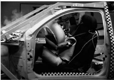
Quando um veículo em alta velocidade para repentinamente, no caso de uma colisão por exemplo, o momento linear do motorista (massa x velocidade) sofre variação de alto valor para zero em um curto intervalo de tempo. Um *air bag* faz com que o motorista perca momento linear de forma mais gradual do que uma colisão abrupta com o volante, reduzindo assim a força exercida sobre o motorista, bem como a probabilidade de lesão.
