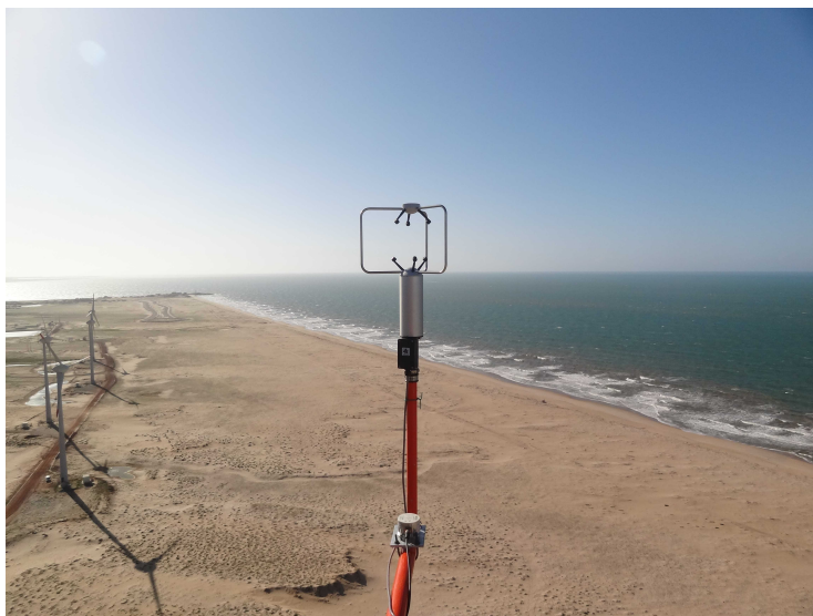
Figura 13 – Anemômetro Sônico instalado na torre anemométrica do parque eólico de Pedra do Sal.
