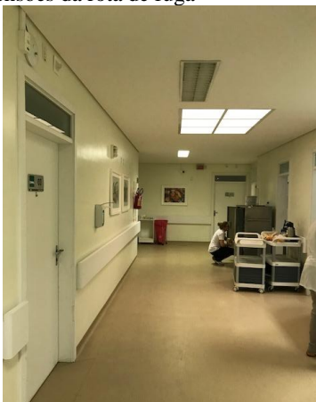
Figura 44: Materiais reduzindo as dimensões da rota de fuga
