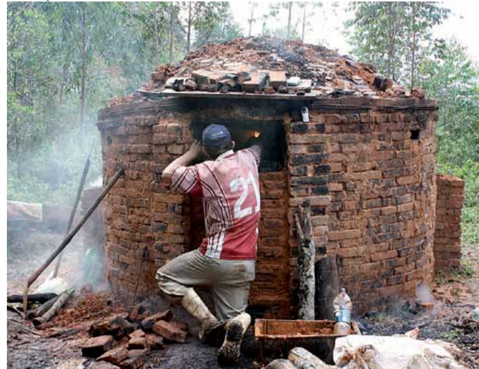
O forno tipo iglu requer a entrada do trabalhador para retirada manual do carvão. O projeto com UFSC e Epagri prevê a implantação de fornos mais adequados à atividade
