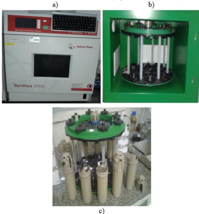
Figura 4.1 – Reator MO Synthos 3000 da Anton Paar. a) Visão externa do reator; b) interior da cavidade do reator com o rotor; c) rotor com os frascos.
