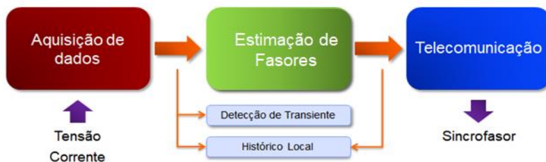
Figura 3.1 - Módulos OpenPMU Versão 2.0. Adaptado: (OPENPMU, 2018)
