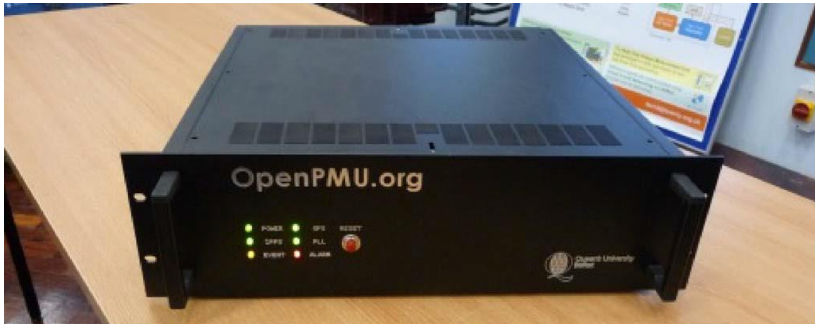
Figura 3.3 - OpenPMU versão Legacy - Montado. Fonte: (LAVERTY et al., 2013).
