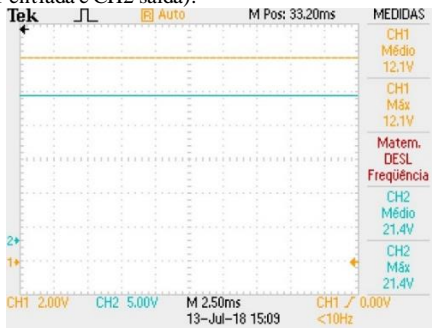
Figura 39 – Tensão de saída do Charge Pump para uma entrada de 12V durante o acionamento dos MOSFETs. (CH1 entrada e CH2 saída).
