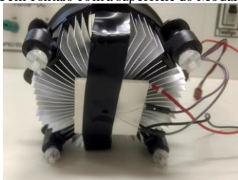
Figura 21 – Termistor NTC 10K em contato com a superfície do Módulo peltier.
