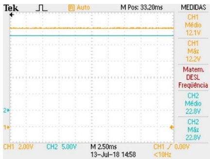
Figura 38 – Tensão de saída do Charge Pump para uma entrada de 12V. (CH1 entrada e CH2 saída).
