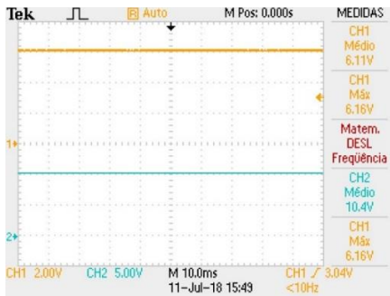
Figura 37 – Tensão de saída do Charge Pump para uma entrada de 6V. (CH1 entrada e CH2 saída).
