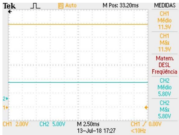
Figura 43 – Valores Medidos pela Ponte-H. (CH1 na entrada do circuito e CH2 nos terminais da Ponte-H).
