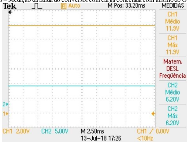
Figura 26 – Medição da Saída do conversor com carga conectada com auxílio do Osciloscópio.
