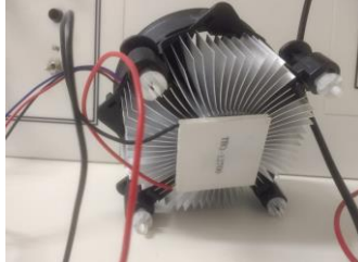
Figura 20 – Módulo Peltier acoplado ao conjunto do dissipador de calor.
