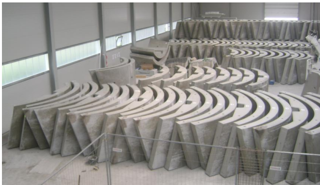
Figura 5.4 – Segmentos de concreto armado (Fonte: o autor)
