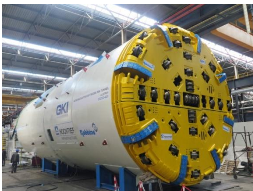
Figura 5.3 – Tuneladora empregada para o túnel de pressão (Fonte: autor)
