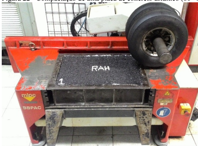
Figura 22 - Compactação de uma placa de concreto asfáltico ( 60 \times 40 \times 9 cm).
