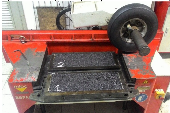
Figura 21 - Moldagem das placas para ensaio de deformação permanente.
