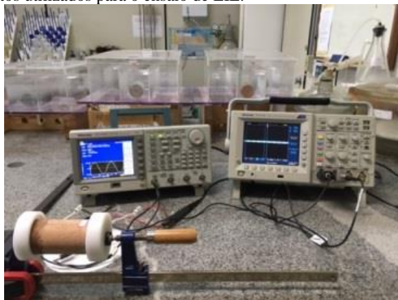
Figura 33 - Bancada experimental do circuito elétrico formado e os equipamentos utilizados para o ensaio de EIE.
