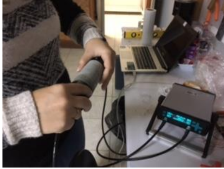
Figura 42 – Método de ultrassom para a determinação do módulo de elasticidade das argamassas.
