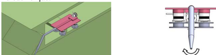
Figura 54 - Sistema de movimentação e ampliação do raio de ação do bico de hidrodemolição.
