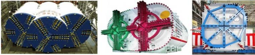
Figura 19 - Tuneladoras de seção não circular desenvolvidas nas décadas de 80 e 90 por fabricantes japoneses.
