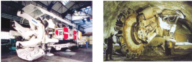
Figura 20 - Máquinas originalmente desenvolvidas para mineração que foram adaptadas para escavação de túneis urbanos.
