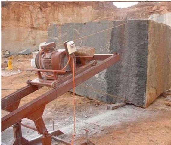
Figura 41 – Sistema de corte de rocha acionado por motor elétrico
